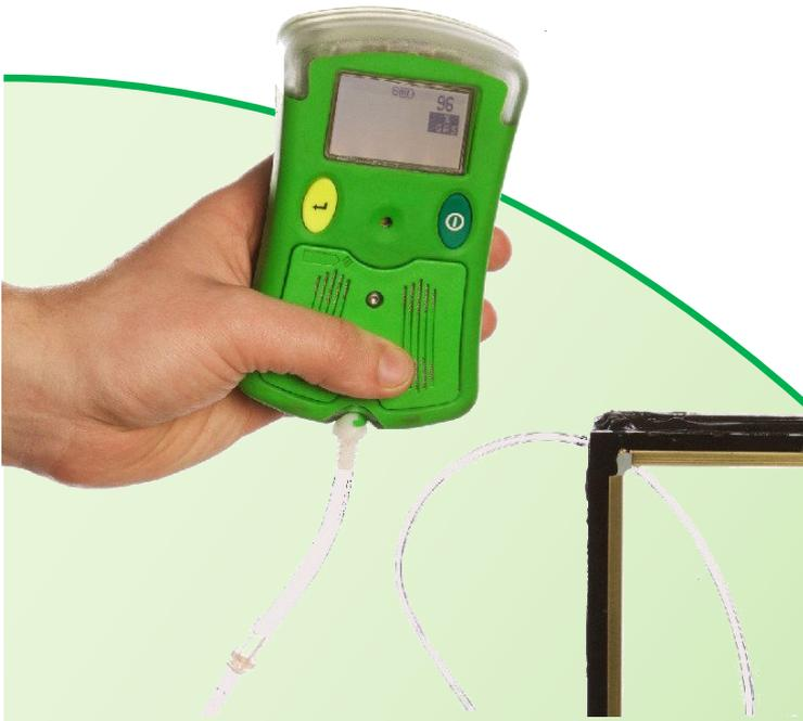
Los fabricantes de vidrio aislante con gas certificados con la norma europea EN 1279 2/3 para unidades de vidrio aislante llenas con gas deben ser capaces de comprobar el porcentaje de gas en las unidades para conservar su certificación y asegurarse una continuidad en la calidad del producto fabricado.
