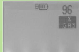
El último instrumento para tal fin, el Testoxy, es de uso intuitivo y fácil, y funciona con baterías recargables. Puede ser usado para medir la concentración de Argon, Krypton, Xenon y mezcla de gases.
