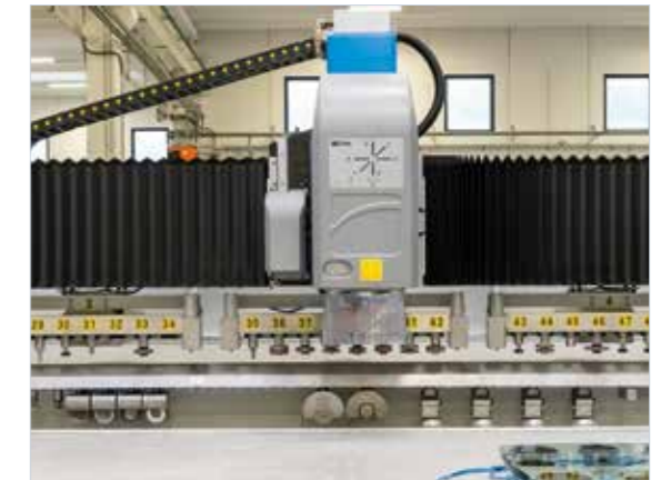
Cargador de herramientas debajo del travesaño con hasta 24 posiciones de los conos.
