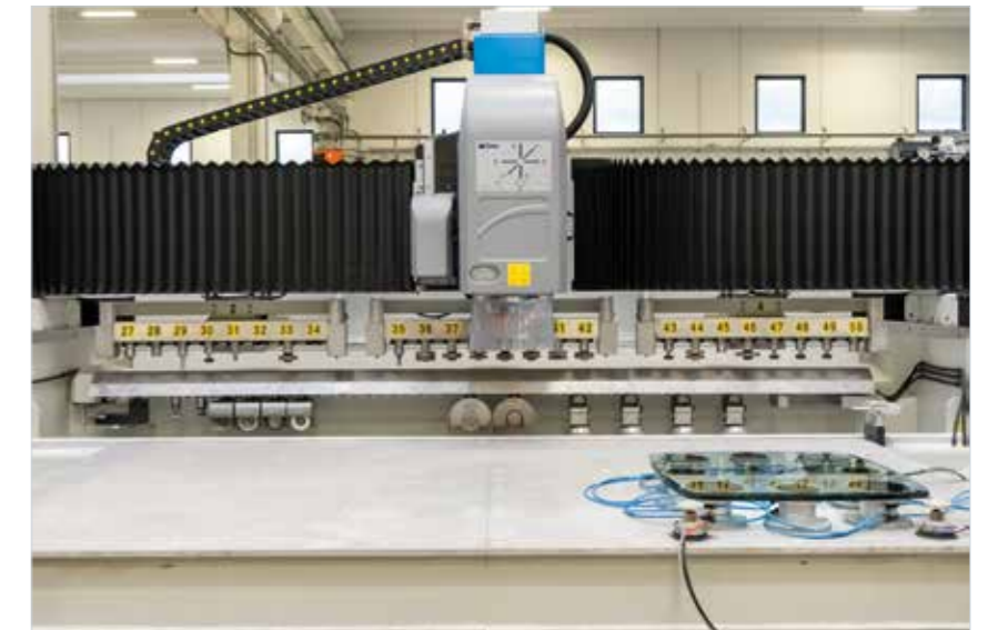
Cargador de herramientas debajo del travesaño con hasta 24 posiciones de los conos.
