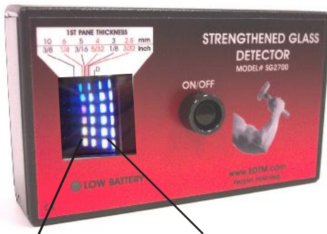
Columna 4 en la izquierda: Reflexión del superficie al fondo del vidrio segundo Columna 1 a la derecha: Reflexión del primer superficie o superficie de contacto.
